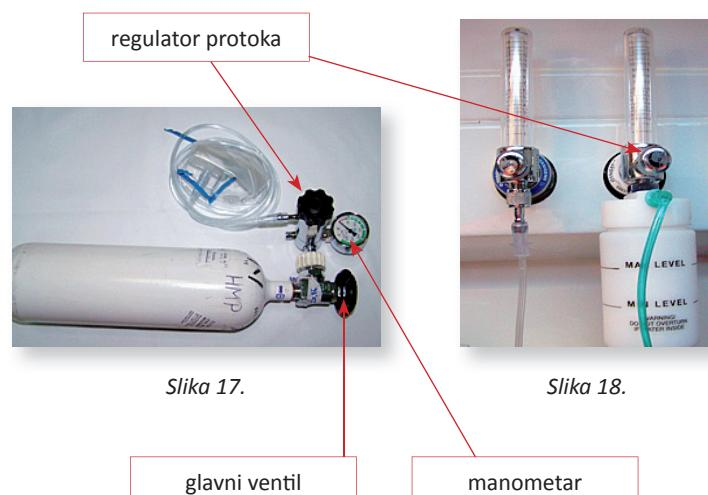
b) **Thorpe tip** je model mjerača protoka kisika s kuglicom u prozirnom plastičnom cilindru koji se primjenjuje u fiksnim sustavima, jer da bi radio mora stajati u okomitom položaju (slika 18.).
